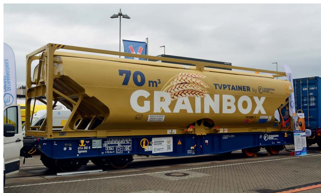
Vůz řady Sgmmns 41' s výsypným kontejnerem TVPcontainer pro přepravu obilovin
